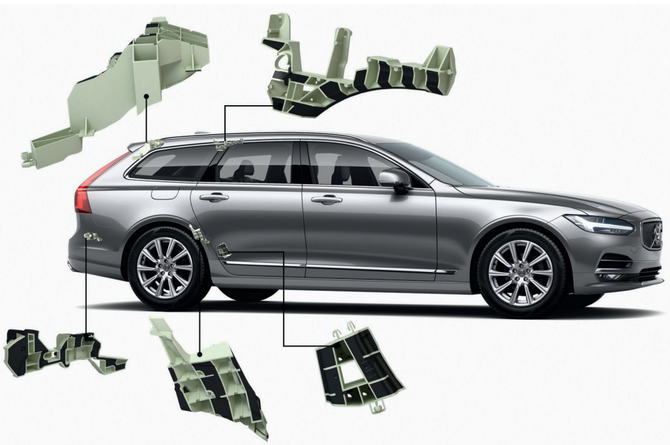
Bild 2. Bei der Entwicklung von Struktureinlegern konnten die Sika-Ingenieure mithilfe des „Altair Design Space“-Workflows zeitaufwendige Arbeitsschritte eliminieren, sodass die Ergebnisse innerhalb von Minuten statt Stunden vorlagen. © Sika
